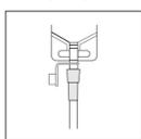
Schließen Sie das beiliegende Verbindungsstück an den Auslaßhahn an und schieben Sie den Schlauch des Nachtdrainagebeutels in das Verbindungsstück.
